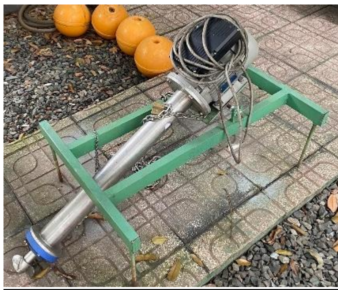
Hình 8. Ảnh chụp Hệ thống sục khí oxy nano được thiết kế và chế tạo tại INT.
