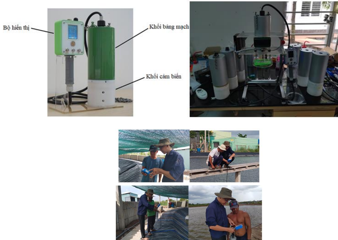
Hình 3. Ảnh chụp hệ thống quan trắc nano đánh giá chất lượng nước ao nuôi trồng thủy hải sản cầm tay được chế tạo tại INT.
