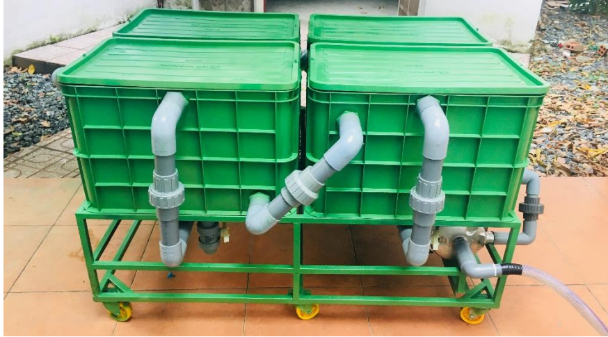
Hình 7. Ảnh chụp Hệ thống lọc nước, khử khuẩn cho nước ao tôm.
