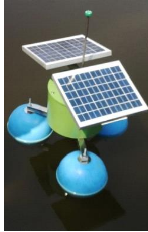
Hình 4. Ảnh chụp Hệ thống cảnh báo xâm nhập mặn tự động dạng thả nổi được thiết kế và chế tạo tại INT.
